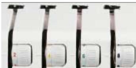
trarsi, o di creare invece l'arricciatura voluta sui vostri capi. Due **MANOPOLE CONCENTRICHE** laterali regolano con la massima precisione i parametri del trasporto differenziale e della lunghezza punto. La regolazione fine delle tensioni si effettua tramite **QUATTRO MANOPOLE** poste frontalmente. La pulizia della macchina è semplice e non prevede complesse operazioni di smontaggio di parti.
